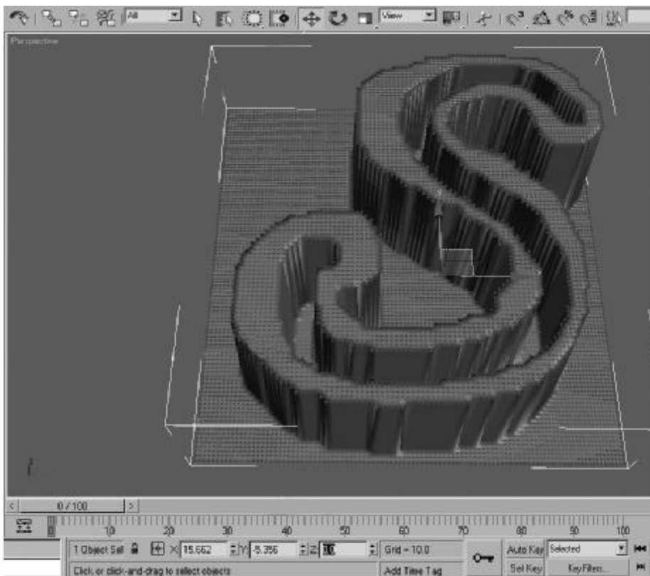
SLIKA 1.11 U prozoru prikaza Perspective izabrane tačke su premeštene na koordinatu Z = 0.0 .
