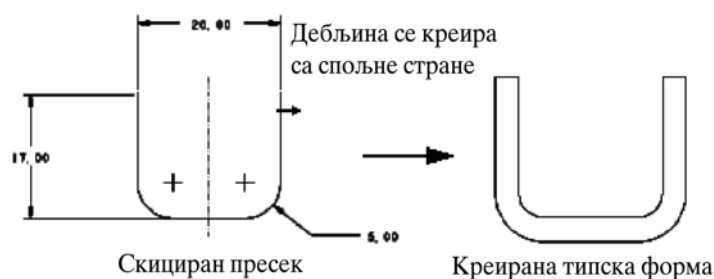
Сл.2.44. Извучена танкозидна типска форма
