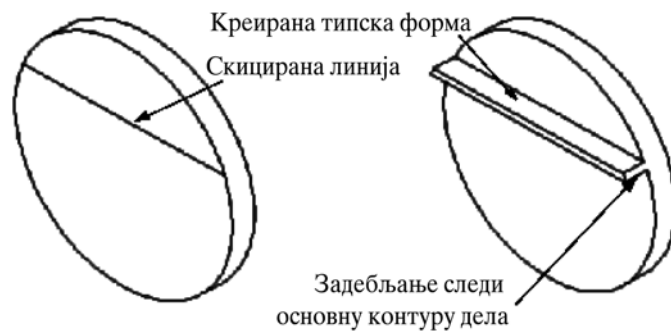
Сл.2.46. Ограничена ивица танкозидне типске форме контуром
