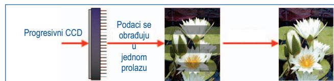
Progresivni CCD senzor je prekriven RGB filterima. Pošto svaki od piksela na slici odgovara jednoj od tri vrste CCD piksela, svaka od tačaka snima samo po jednu boju. Procesor za obradu slike proračunava podatke o bojama koje nedostaju i dovršava sliku. Sto je bolji procesor za obradu slike, to će završni rezultat biti kvalitetniji.
