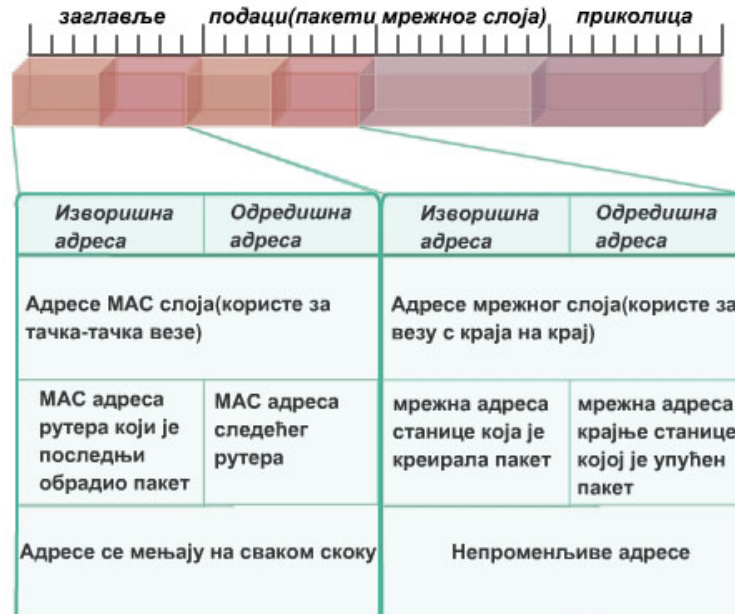
Слика 4. 6 Структура рама који се преноси кроз мрежу
