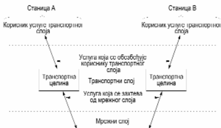
Слика 2. 1 Веза мрежног, транспортног и виших слојева
