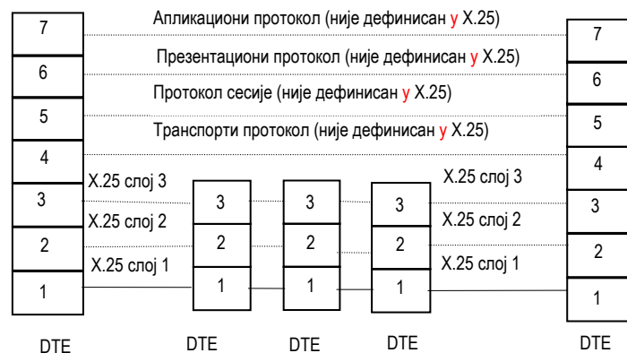
Слика 1.12 Упоредба X.25 и OSI референтних модела
