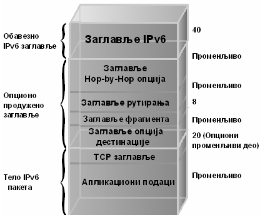
Слика 4.1 IPv6 пакет са продуженим заглављима
